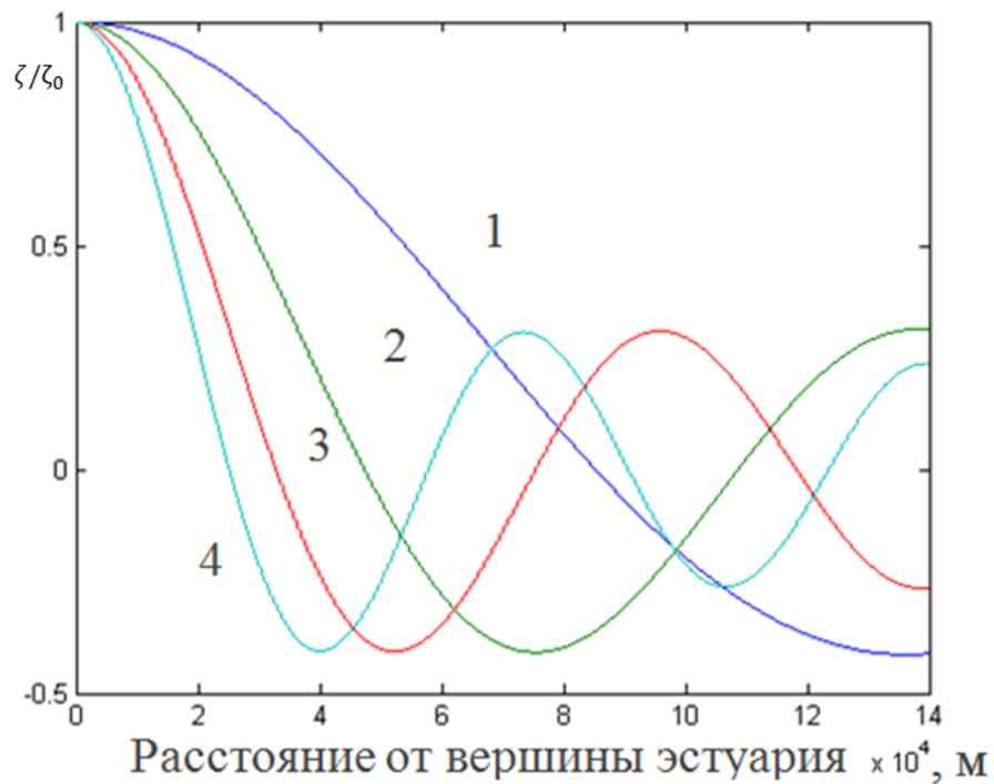
Рисунок 49 – Первые четыре моды сейшевых колебаний в эстуарии постоянной глубины при H = 30 м
