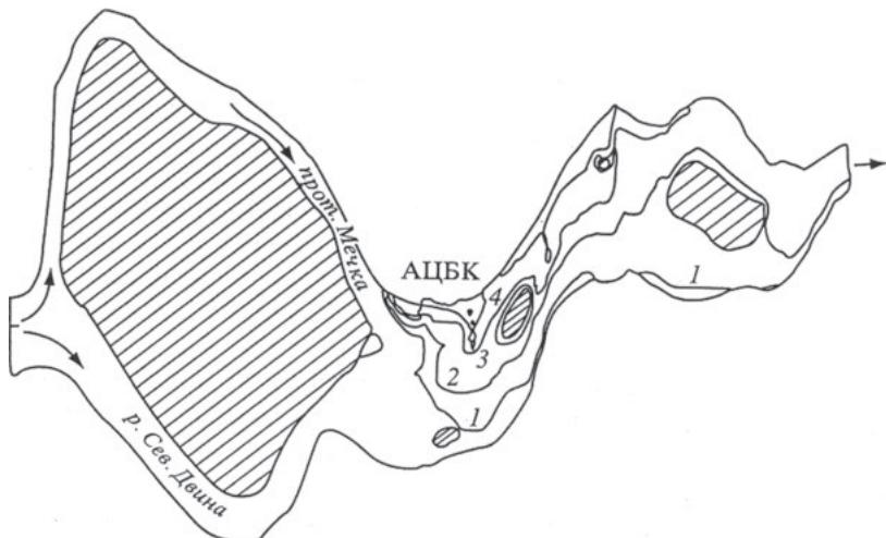
Рис. 1. Схема расчётного участка и поле концентраций лигниновых веществ через четверо суток после начала работы рассеивающего выпуска: 1–5 мг/л; 2–10 мг/л; 3–15 мг/л; 4–30 мг/л
