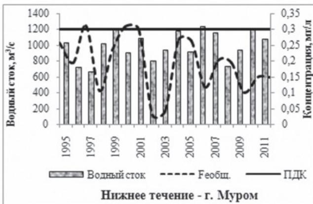
Рис. 5. Карта распределения содержания общего железа в бассейне р. Ока и график его временной динамики в створе г. Муром [7; 10]
