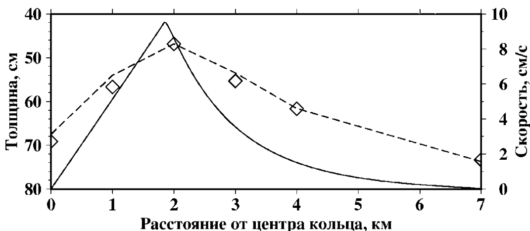
Рисунок 52. Изменение на поперечном полуразрезе через кольцевую структуру средней измеренной толщины льда (ромбы), ее рассчитанных по модели величин (штриховая линия) и модуля скорости подледного течения, по модели Стегнера (сплошная линия).
