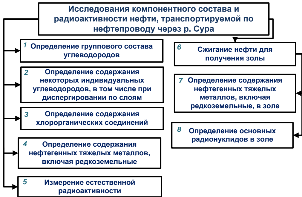
Рисунок 3.9 – Процедура анализа углеводородных компонентов нефти и некоторых неорганических компонентов.
