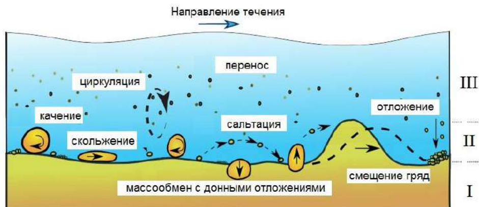
Рисунок 2.1 – Формы транспорта руслообразующих наносов, рассматриваемые в программном комплексе STREAM 2D CUDA
