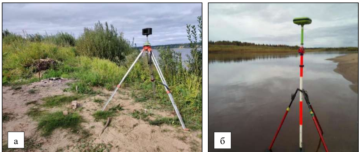
Рисунок 3.10 – Измерения уровней воды методом дифференциального спутникового позиционирования с установкой приемника Javad Triumph-VS на временном репере (а) и Javad Triumph-1 на урезе (б)
