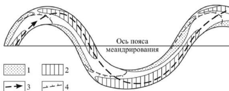
Рисунок 1.11 – Типичное расположение плесов, перекатов и прирусловых отмелей на излучинах: 1 – отмели; 2 – плесы; 3 – динамическая ось потока; 4 – подвалья перекатов [Чалов и др., 2004].
