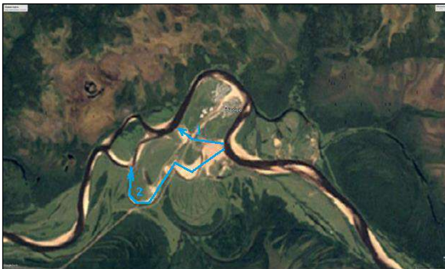
Рисунок 3.21 – Космический снимок района Быченского сельского поселения 1997 г. (источник – Google-Earth). Голубые стрелки обозначают трассы возможного спрямления излучин.
