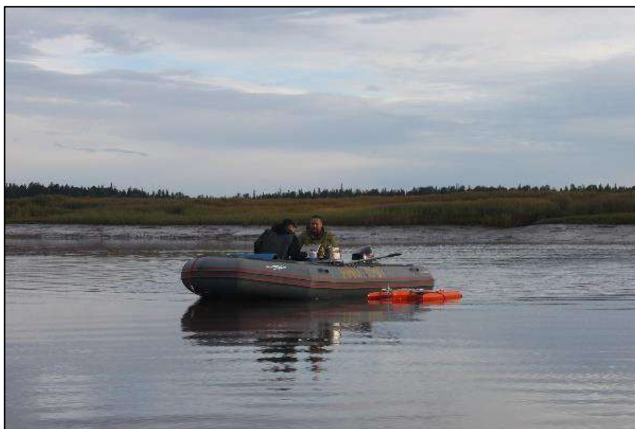
Рисунок 3.11 – Измерение расходов воды и скоростного поля потока акустическим доплеровским профилографом RiverRay
