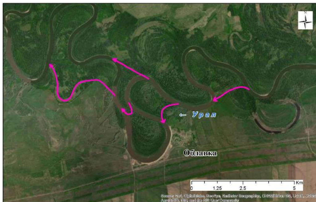
Рисунок 4.4 – Схема возможных прорывов излучин р. Урал вдоль границы России и Казахстана в районе с.Облавка.
