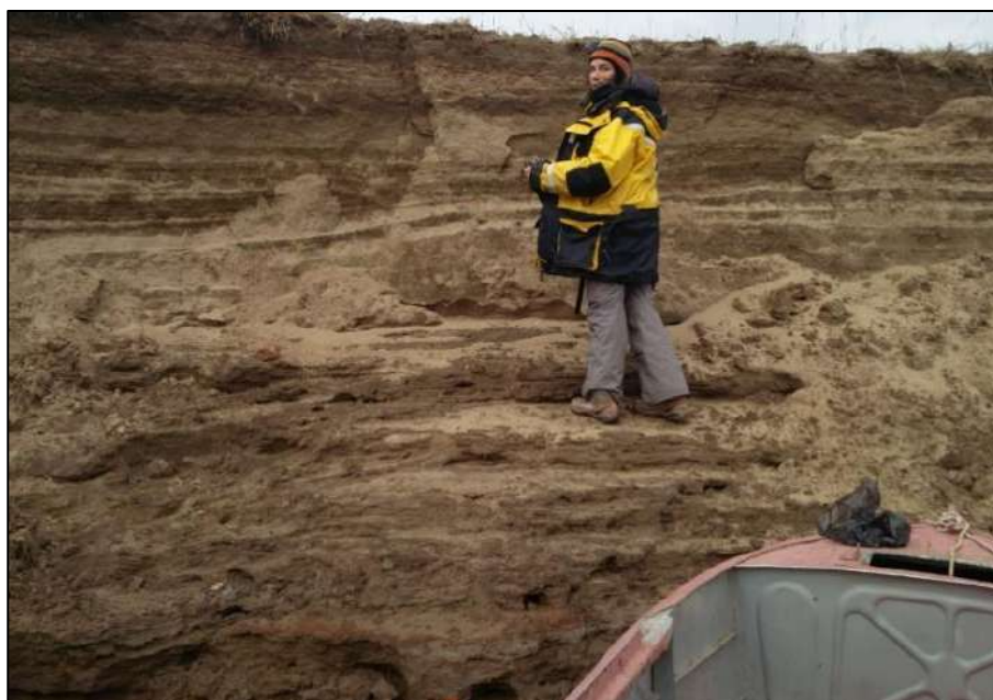
Рисунок 3.13 – Отбор образца грунта на месте прорыва излуцины из обрыва правого берега спрямляющей протоки
