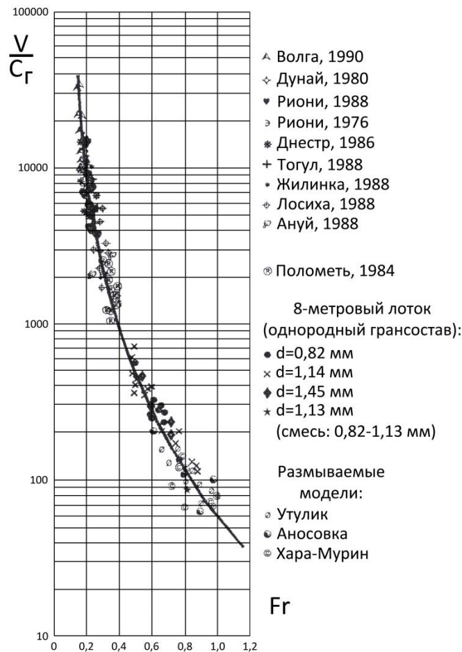
Рисунок 5.1 – Кривая C_T = 0,019VFr^3 на фоне независимых данных
