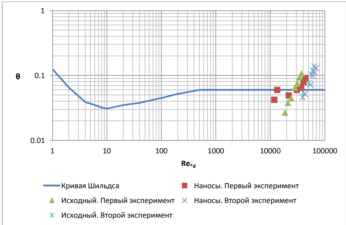
Рисунок 2.7 – Степень подвижности донных наносов в первом и втором экспериментах по бесструктурному транспорту относительно кривой Шильдса при расчетах с исходным грансоставом донных отложений и грансоставами наносов
