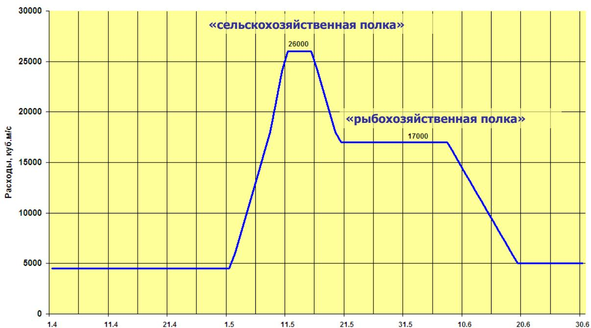
Рисунок 5.9 – Типовой график специального весеннего попуска через Волгоградский гидроузел в низовья Волги
