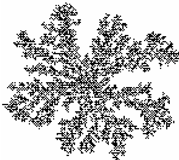
Рис. 4. Модель фрактального кластера (расчет методом Монте-Карло [17]).
