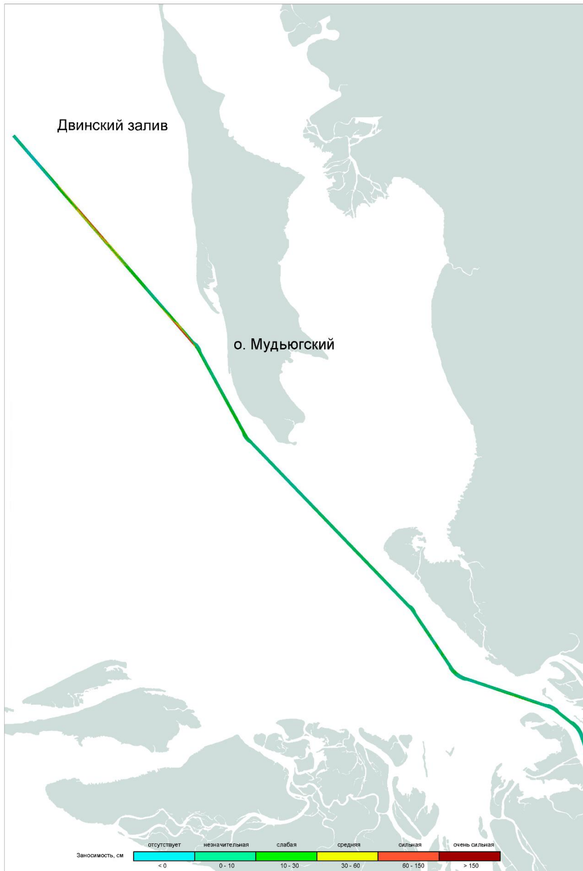
Рисунок 46. Пространственное распределение заносимости на каналах в устьевом взморье морского порта Архангельск.
