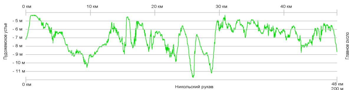
Рисунок 6. Продольный профиль Никольского рукава области реки Северная Двина по материалам съемок рельефа дна ФГУП «Росморпорт» (2010 – 2020 гг.)
