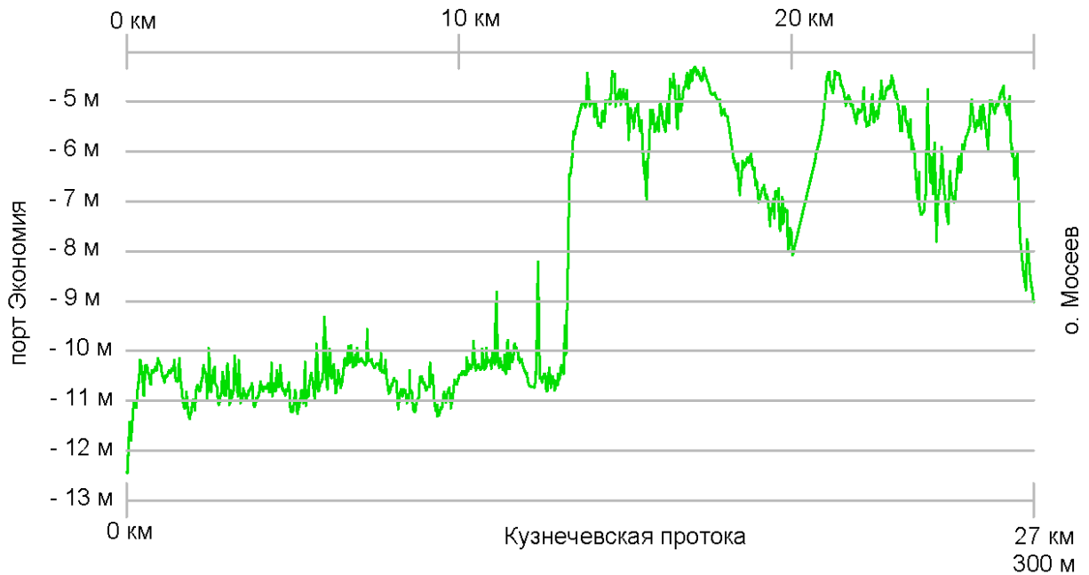
Рисунок 10. Продольный профиль судходного фарватера Маймаксанской протоки устьевого участка реки Северная Двина по материалам съемок рельефа дна ФГУП «Росморпорт» (2010 – 2020 гг.)
