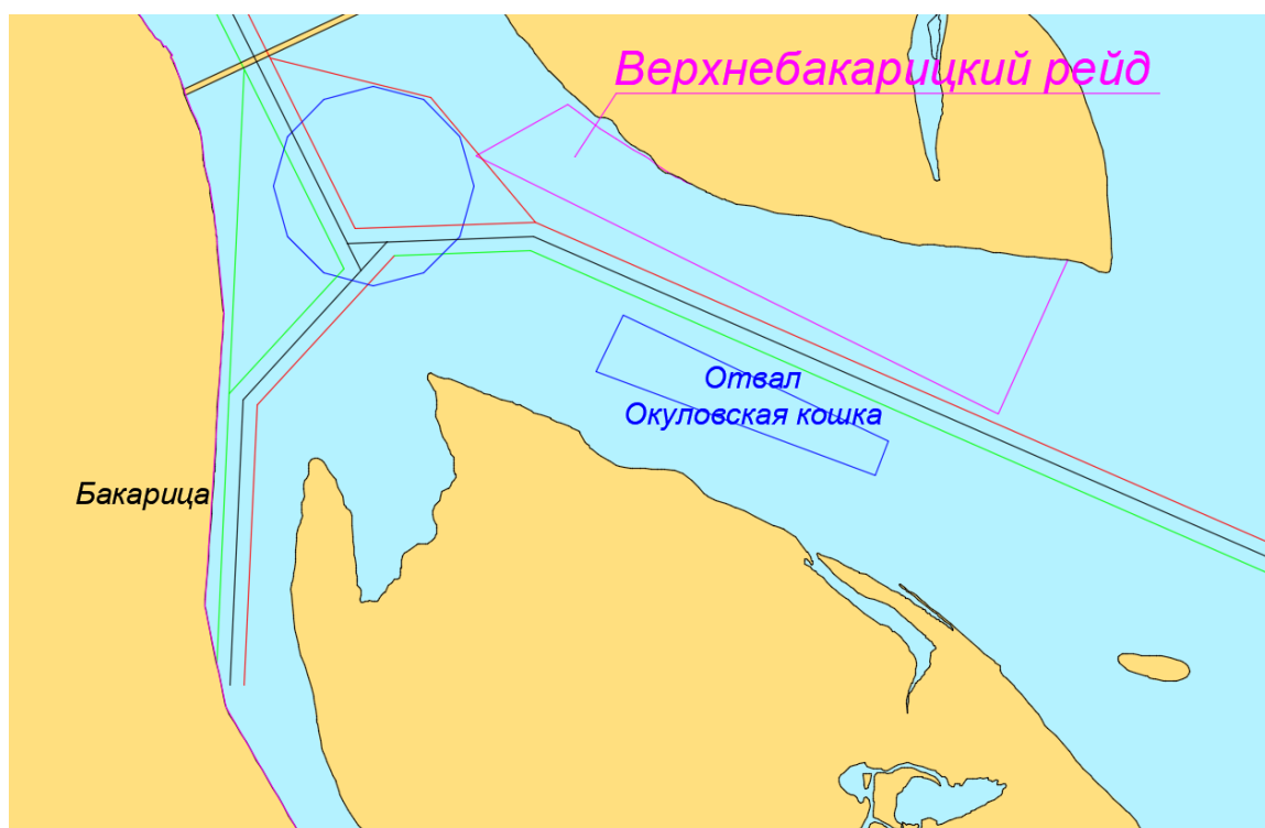
Рисунок 34. Схема расположения подводных отвалов грунта №147-А в районе о. Окуловская кошка.
