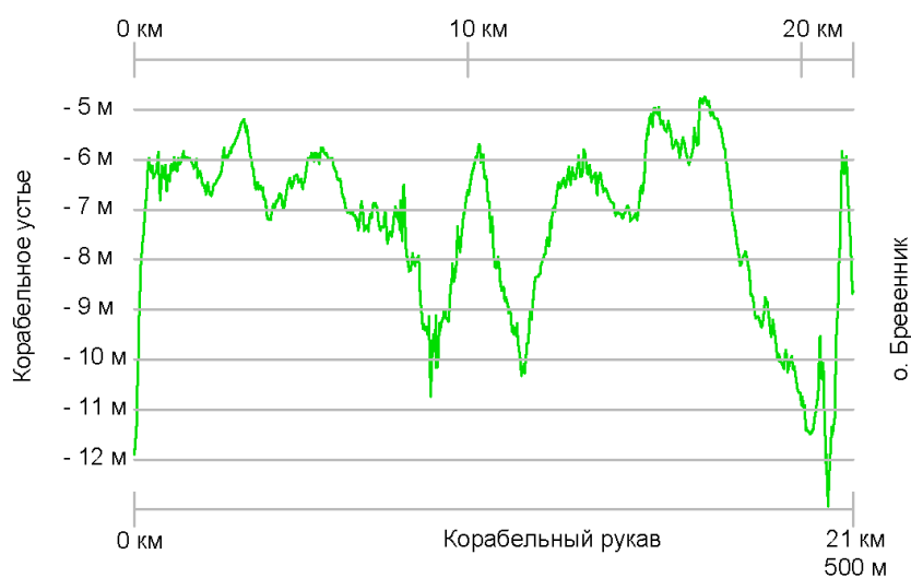
Рисунок 8. Продольный профиль Корабельного рукава устьевой области реки Северная Двина по материалам съемок рельефа дна ФГУП «Росморпорт» (2010 – 2020 гг.)
