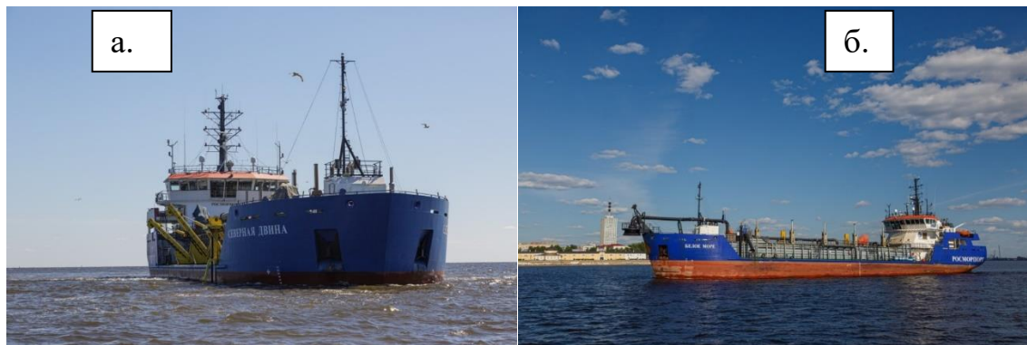
Рисунок 29. Самоотвозные трюмные землесосы «Северная Двина» (а) и «Белое море» (б) Архангельского филиала ФГУП «Росморпорт»
