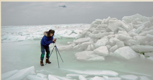
Съёмка морфометрических характеристик торосов (Северный Каспий)
