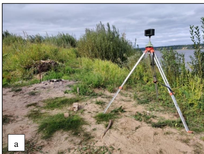
Рисунок 3.10 – Измерения уровней воды методом дифференциального спутникового позиционирования с установкой приемника Javad Triumph-VS на временном репере (а) и Javad Triumph-1 на урезе (б)
