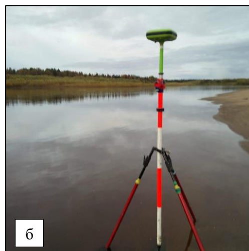
Рисунок 3.10 – Измерения уровней воды методом дифференциального спутникового позиционирования с установкой приемника Javad Triumph-VS на временном репере (а) и Javad Triumph-1 на урезе (б)
