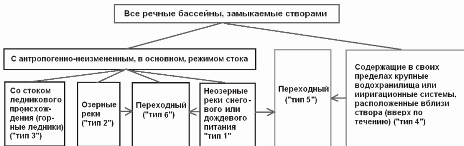
Рис. 2.1.3. Схема выделения типов речных бассейнов
