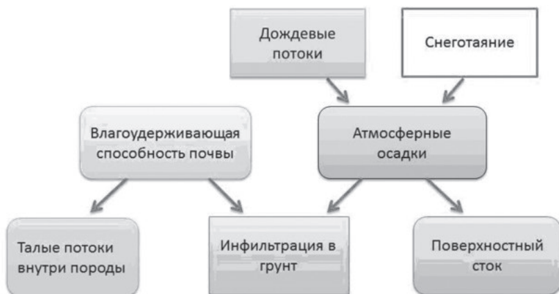
Рис. 3. Схема распределения потоков жидкости при оттаивании мёрзлых грунтов
