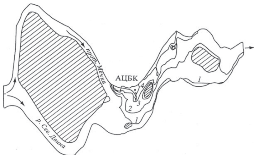
Рис. 1. Схема расчётного участка и поле концентраций лигнинных веществ через четверо суток после начала работы рассеивающего выпуска: 1–5 мг/л; 2–10 мг/л; 3–15 мг/л; 4–30 мг/л
