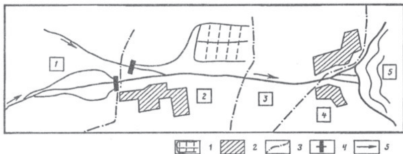
Рис. 1. Схема водохозяйственного бассейна: цифры в квадратах - субъекты водопользования: 1 – орошаемые земли, 2 – промышленные и городские объекты, 3 – административные границы, 4 – гидротехнические сооружения, 5 – направление течения реки
