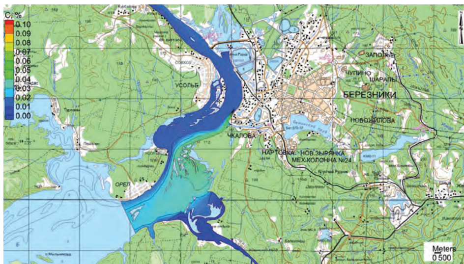
Рис. 2.59. Зона распространения ЗВ от сброса с ООО «Промстоки», участок р. Кама от населённого пункта Пыскор до г. Орел
