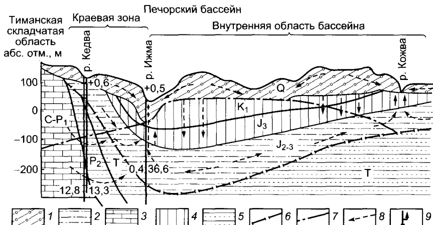
Рис 10.8. Схема гидродинамической зональности юго-западного борта Печорского артезианского бассейна: 1 — водоносный комплекс четвертичных отложений; 2 — верхне-среднеюрских; 3 — каменноугольных и пермских отложений; слабопроницаемые породы; 4 — нижнемелового—среднеюрского возраста; 5 — триасового возраста; 6 — граница первого этажа бассейна; 7 — границы гидродинамических зон; 8 — направления движения подземных вод; 9 — скважины, цифры: внизу — минерализация подземных вод (г/л), вверху — глубина установившегося уровня (м)
