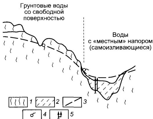
Рис. 9.3. Схема разгрузки грунтовых вод зоны экзогенной трещиноватости: 1 — трещиноватые скальные породы, 2 — рыхлые слабопроницаемые отложения, 3 — уровень грунтовых вод, 4 — источники, 5 — скважина, стрелка — величина местного напора подземных вод
