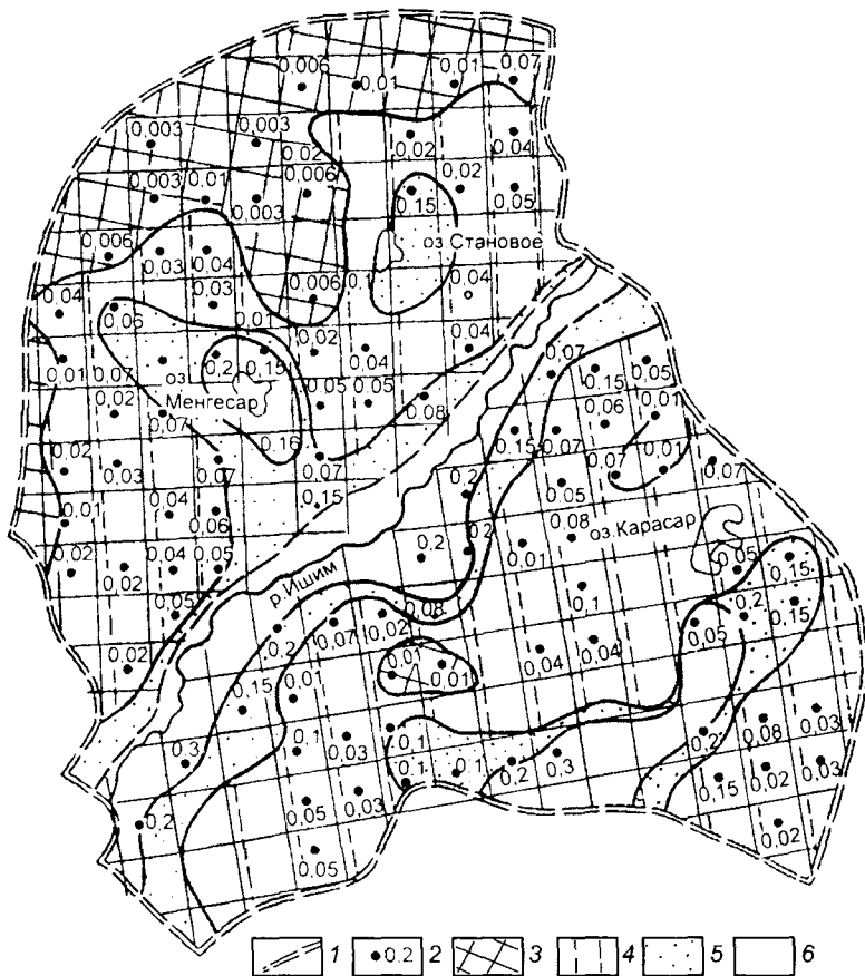
Рис. 13.1. Распределение величин инфильтрационного питания на территории Приишимской равнины (южная часть Западно-Сибирской низменности): 1 — границы расчетного участка; 2 — расчетный блок, цифра — величина инфильтрационного питания, л/с \cdot км^2 ; 3–6 — величины инфильтрационного питания, л/с \cdot км^2 ; 3 — менее 0,01; 4 — 0,01–0,1; 5 — 0,1–0,2; 6 — 0,2–0,5
